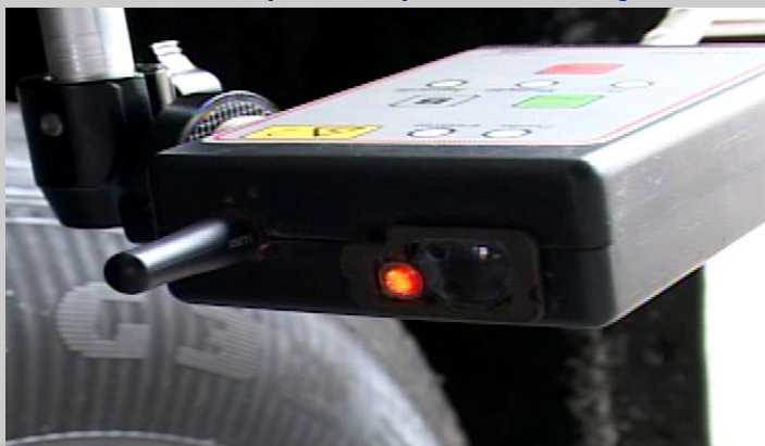
Trena laser adaptada para medição linear.
