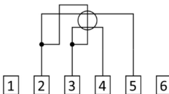
Medidor sem relé interno
