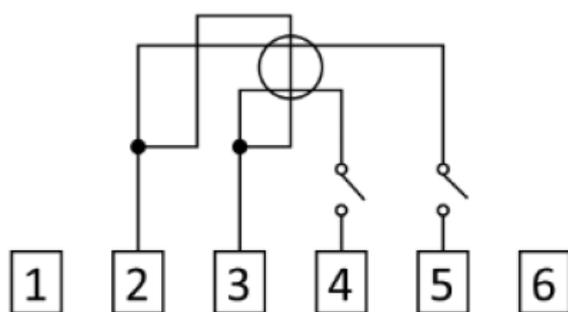
Medidor com relé interno
