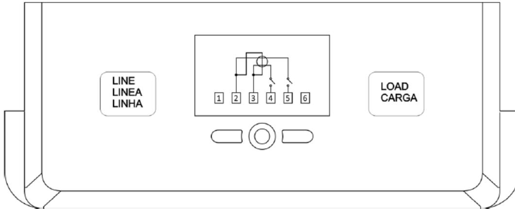
O esquema de ligação é gravado na tampa do bloco de terminais
