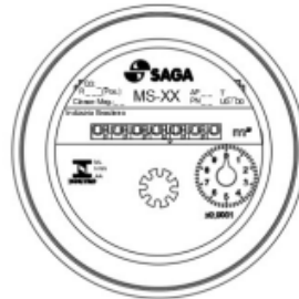
RELOJOARIA 45° CÚPULA DE VIDRO SEM ENCAIXE PARA SENSOR
