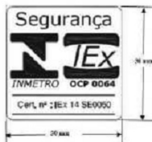
Etiqueta de identificação aprovação INMETRO para uso em área classificada (Ex)
