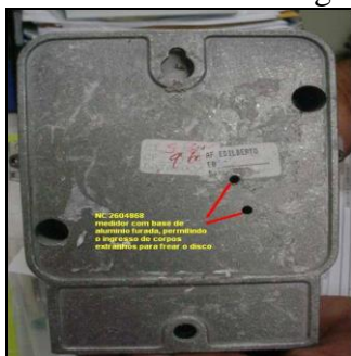
Figura 5 – Vista traseira da base de um medidor de energia elétrica, com a presença de furos
