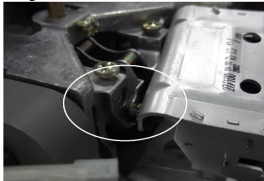
Figura 21 – Registrador desconectado da estrutura do medidor
