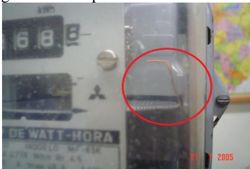
Figura 15 – Corpo estranho travando disco
