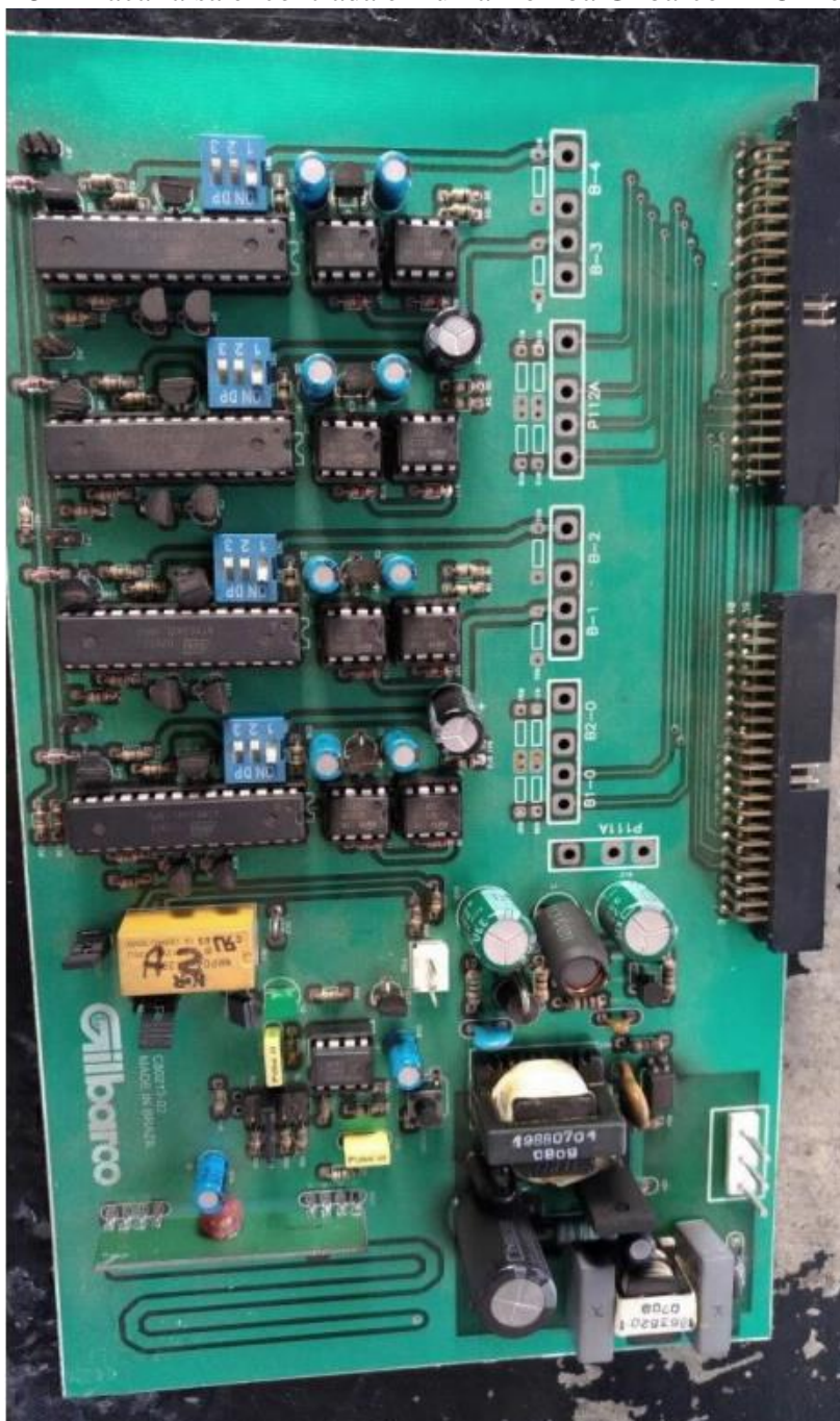
Figura A125 – Placa falsa encontrada em uma Bomba Gilbarco PRO 2 e GBR 111
