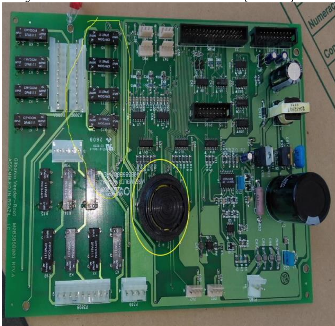
Figura A20 – Interface hidráulica com microcontroladores [escondidos] sob relês
