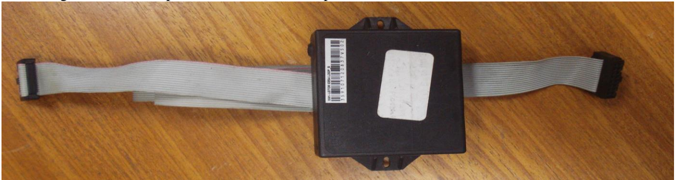
Figura A100 – Dispositivo inserido entre a placa de interface hidráulica e a CPU da bomba
