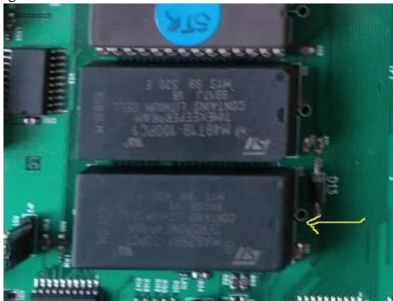
Figura A58 – Há um microcontrolador sob a memória indicada
