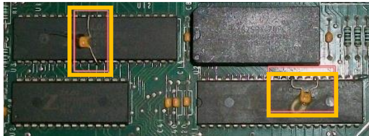
Figura 13 – Capacitores originais incrementados na PCI após fabricação
