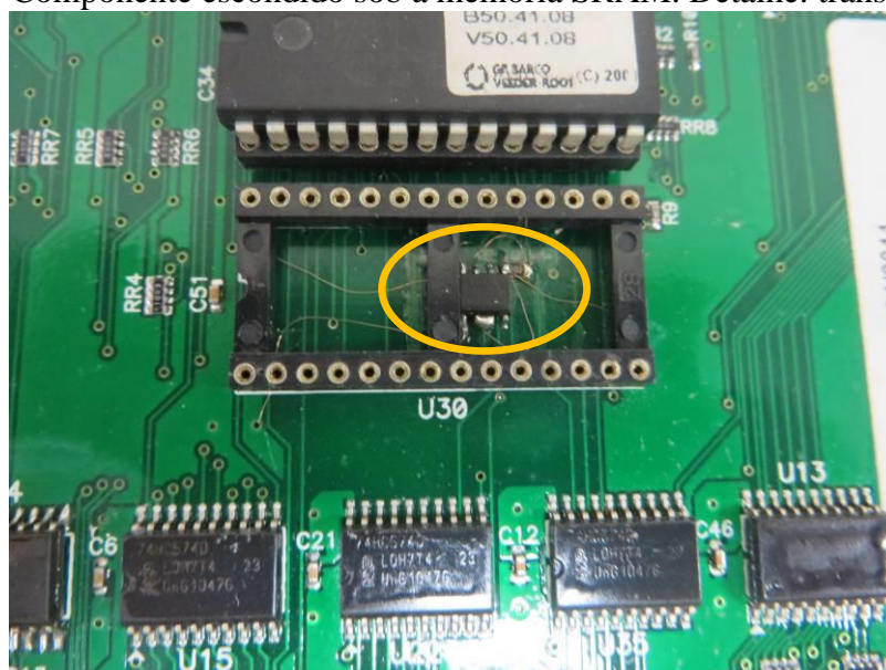
Figura A42 – Componente escondido sob a memória SRAM. Detalhe: transceptor RS-485
