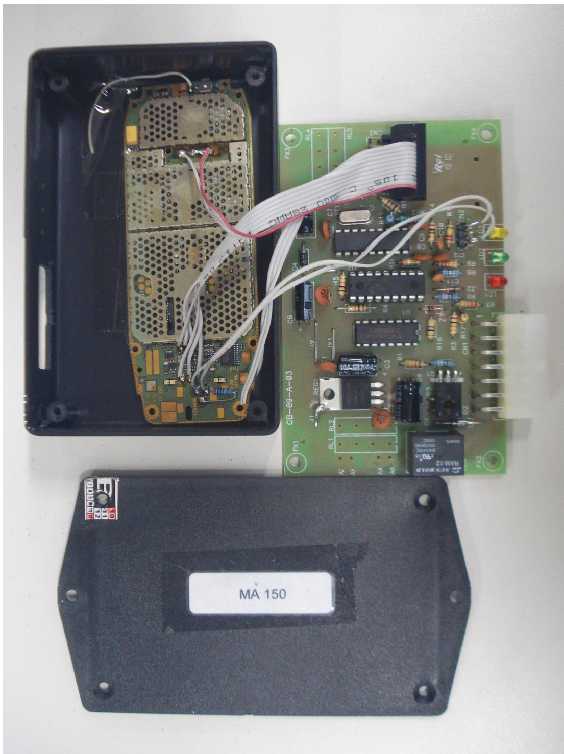
Figura A124 – Destaque 3 – módulo com GSM e seus componentes internos. Este módulo é utilizado para acionamento/desativação da fraude através de uma chamada telefônica de celular.
