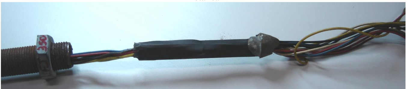
Figura A97 – PCI responsável pela fraude protegida com material isolante encontrada na tubulação metálica
