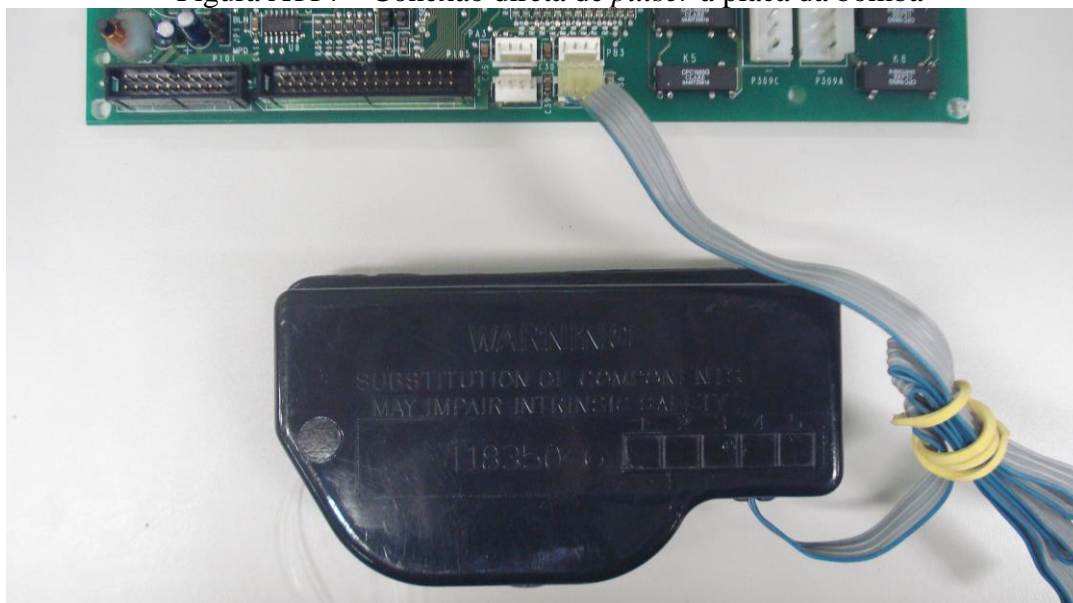
Figura A114 – Conexão direta de pulser à placa da bomba
