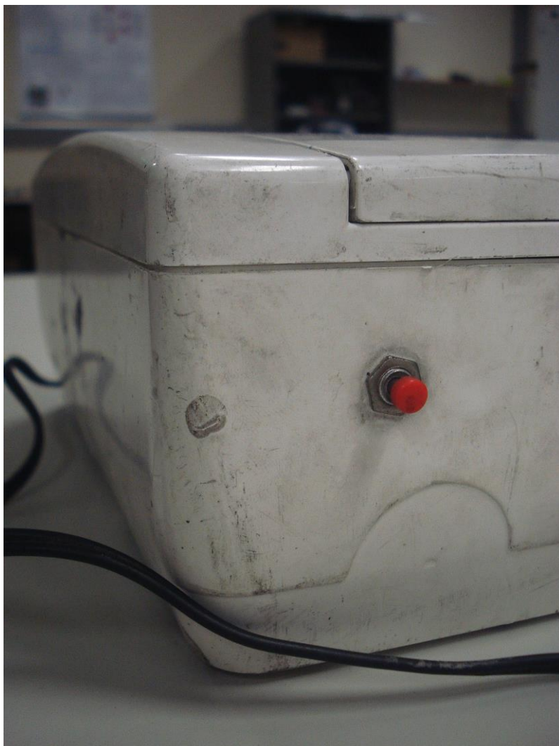
Figura A118 – Botão externo de emergência para desativação da fraude
