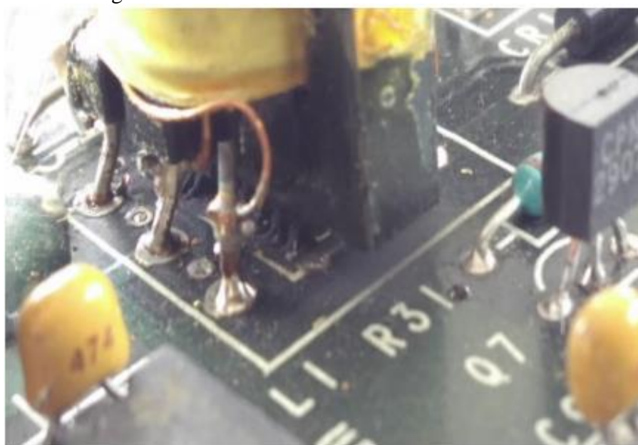
Figura A28 – Microcontrolador sob transformador.
