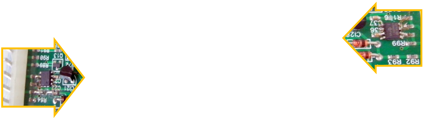
Figura A36 – Placa CPU original adulterada com fraude (modelo 2); detalhe dos componentes acrescentados.
