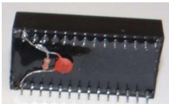
Figura A54 (c) – Detalhe de implementação da fraude de encerrante na memória SRAM.
