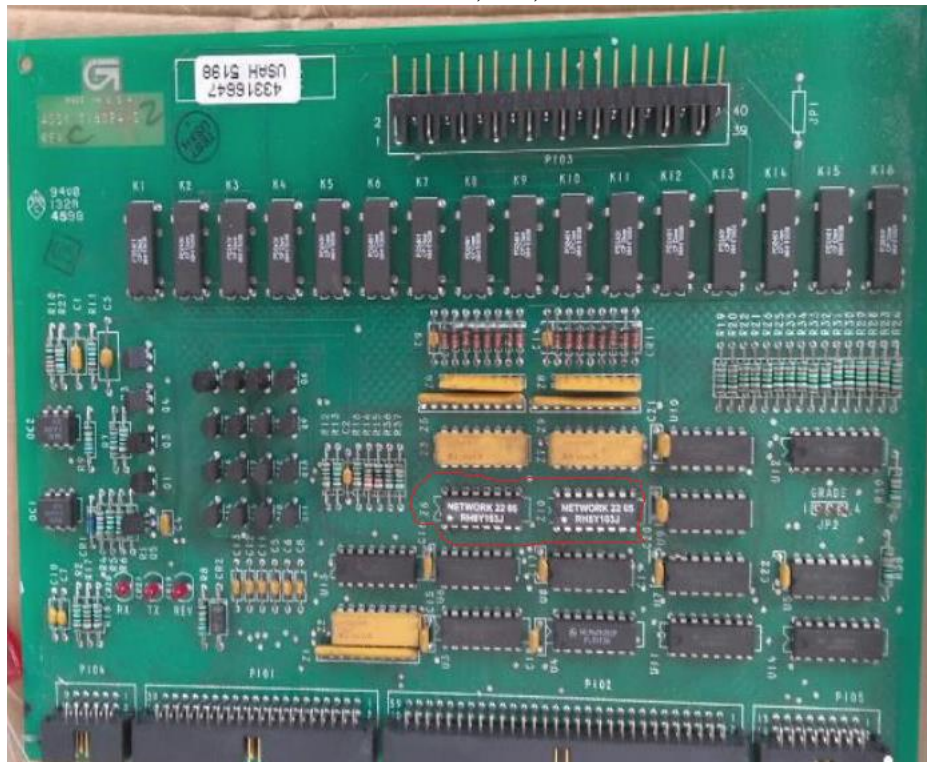
Figura A23 - Placa Hidráulica utilizada em bombas Pro-2, HH 2/4, E 2/4, E2/6, Titan, Encore KH12 e ADV 2/1, 2/4, 2/6
