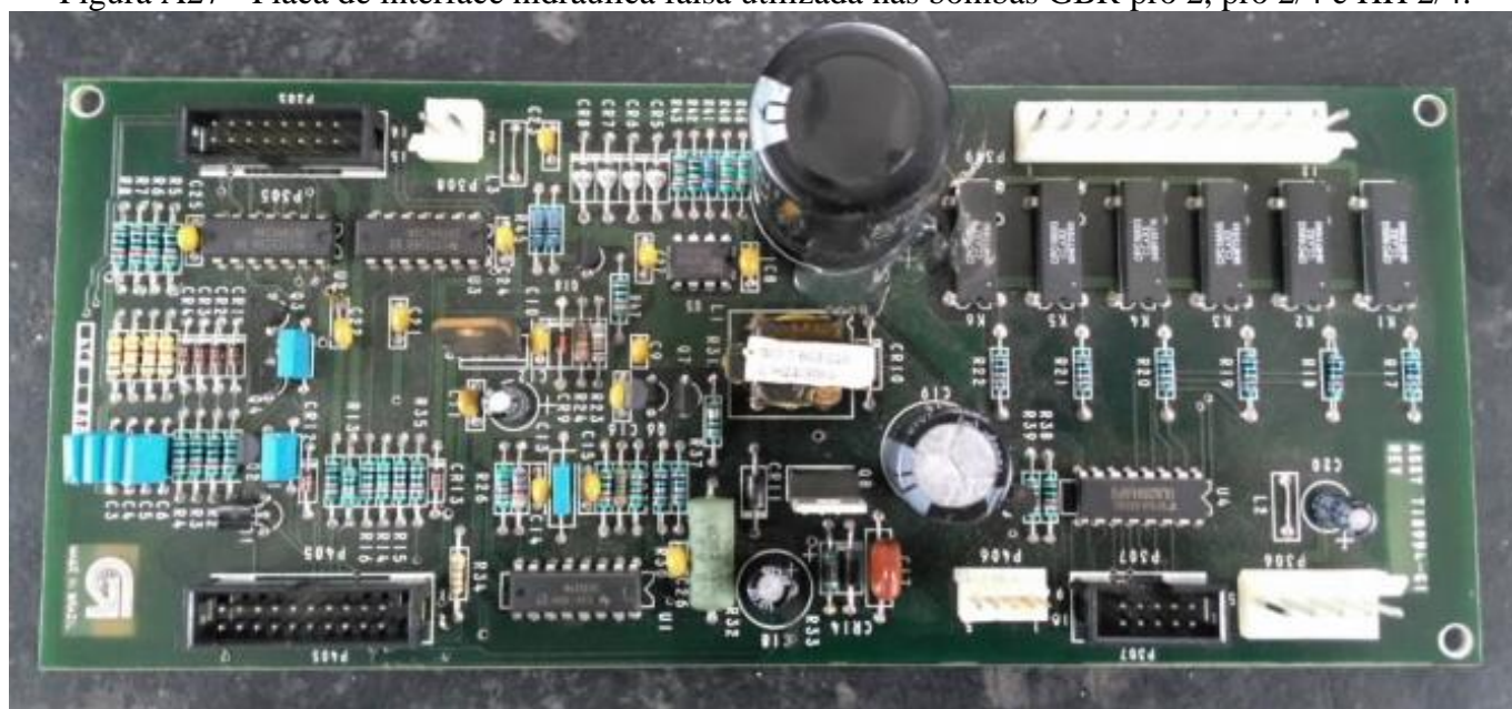
Figura A27 - Placa de interface hidráulica falsa utilizada nas bombas GBR pro 2, pro 2/4 e HH 2/4.
