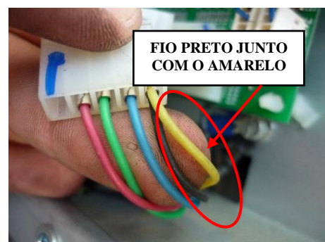
Figura A77 – O fio amarelo que deveria estar junto com o preto está sendo usado para o acionamento, sendo que no padrão de fábrica os dois ficam juntos geralmente.
