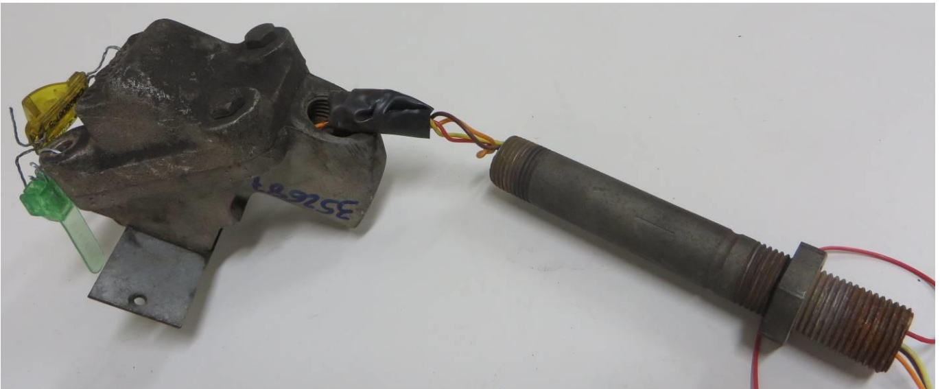
Figura A90 – Desmontando a tubulação metálica encontra-se parte da fiação envolvida em material isolante
