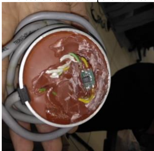
Figura A13 – Microcontrolador e componentes inseridos na resina.
