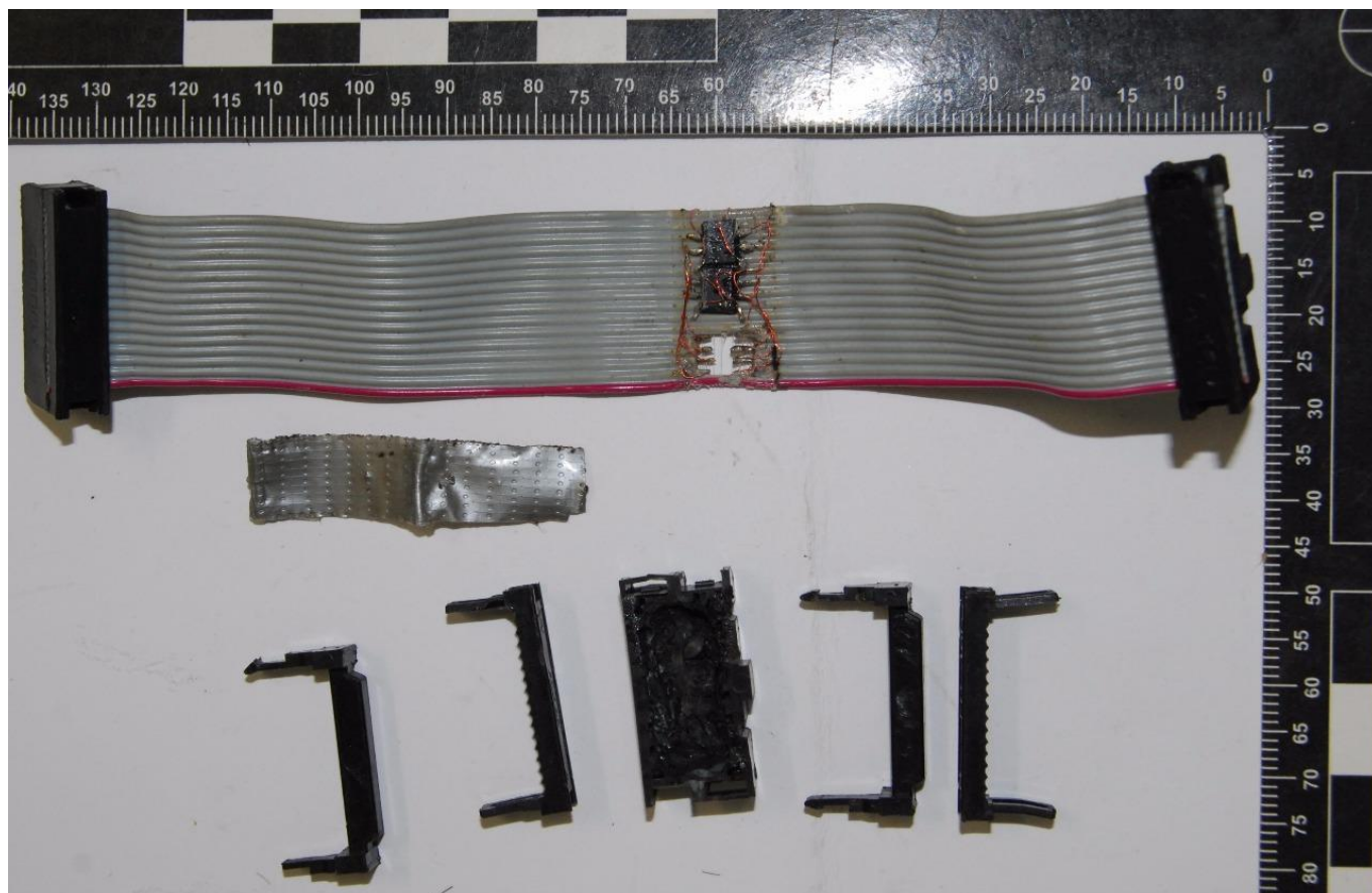
Figura A104 – Cabo de conexão entre CPU e interface hidráulica, microcontroladores escondidos.
